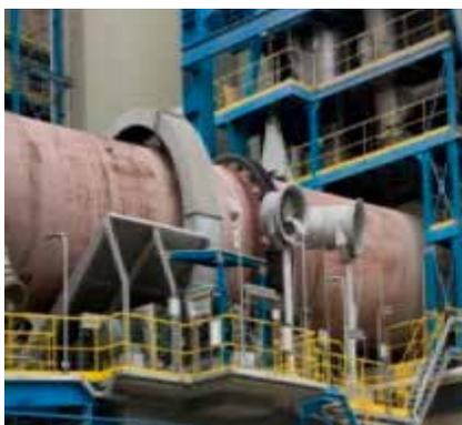
forno rotante per la lavorazione del cemento
